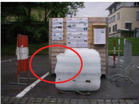
Nach drei Monaten wurde am 23. Mai 2010 der Zeller Eisblock enthüllt. Das Ergebnis war ein beeindruckender Beweis für die Effektivität moderner Wärmedämmung. Mehr als 70% des einen Kubikmeter großen Eisblocks hatten in einer Hülle mit einem U-Wert von 0,16 W/m<sup>2</sup>K den Frühling überdauert.
